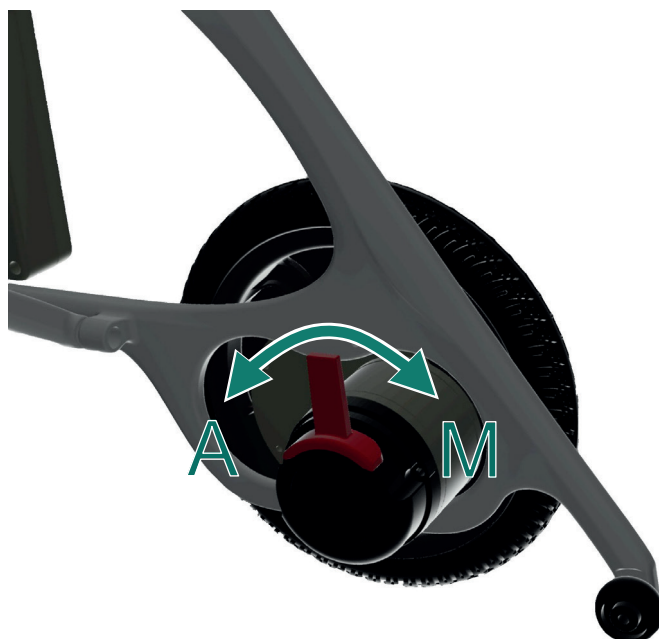
Figura 11: Palanca de freno (funcionamiento automático/manual)
