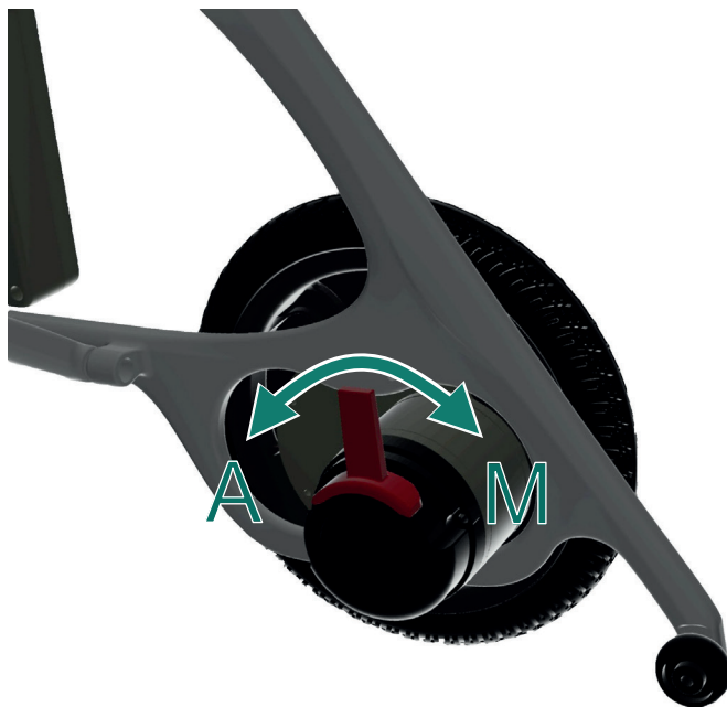
Figura 2: Palanca de freno (funcionamiento automático/manual)
