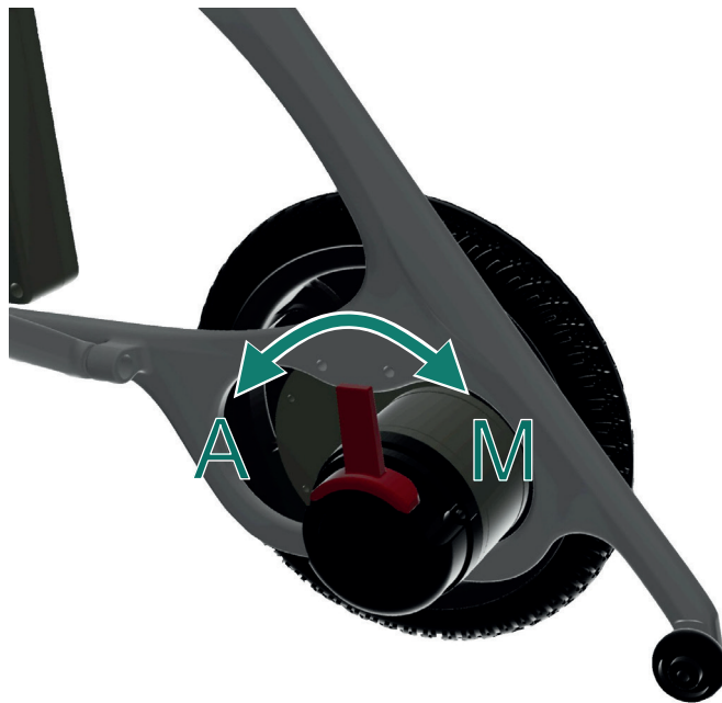
Abbildung 11: Bremshebel (automatischer/manueller Betrieb)
